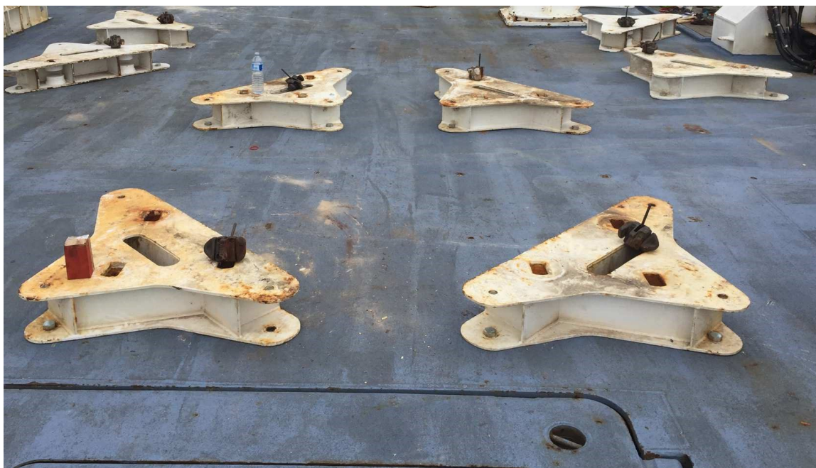
photo d'un ensemble patte d'éléphant et twist lock (disposées pour réception d'un conteneur 10 pieds)
