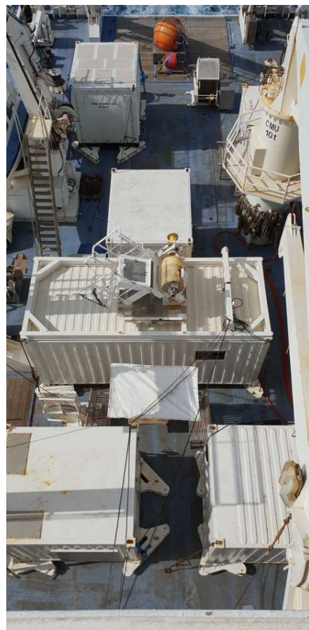
ci-dessous : vue de la plage arrière avec interface pour conteneur 40 pieds à poste et bossoirs vedettes débarquées / ci-dessous : plage arrière en 2019 mission sismique (SISRAP 2D) genavir
