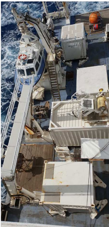
ci-dessous : vue de la plage arrière avec interface pour conteneur 40 pieds à poste et bossoirs vedettes débarquées / ci-dessous : plage arrière en 2019 mission sismique (SISRAP 2D) genavir
